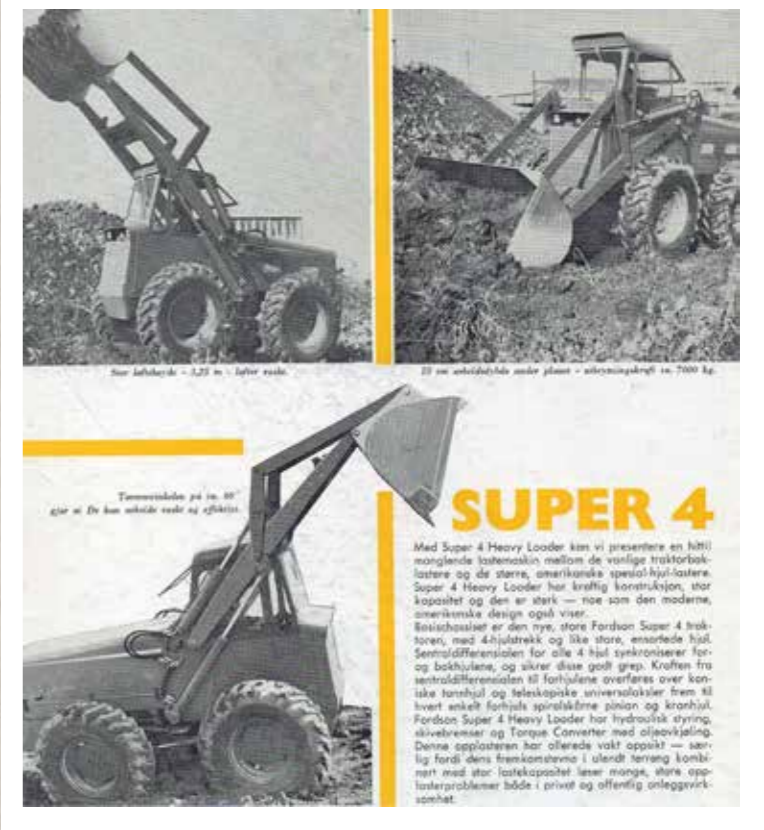
County på trøndersk: Relløms Heavy Loader ble den ultimate hjullaster basert på en traktorkropp.
